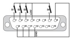
Fig. 15: J3 connector : digital input wiring
