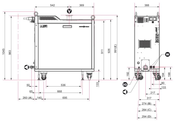
Fig. 25: A 1204H, A 1504H, A 1504X, A 1804H, A 1804X - Dimensions (mm)
