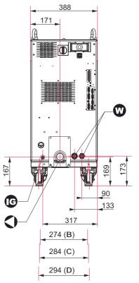
Fig. 24: A 604H, A 804H, A 804X - Dimensions (mm)
